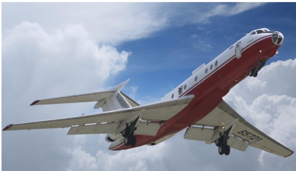
Рисунок 61 Самолет-лаборатория ТУ-134 «Оптик». Фотография ИОА СО РАН.
